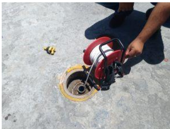
Figura 27: Monitoramento de água subterrânea com Interface 122
